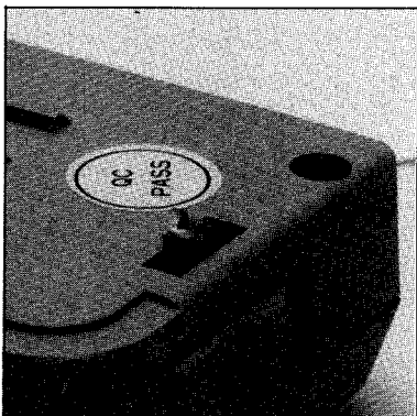
Abb. 5: Chicony-Akku mit abgeknickter „Nase“
